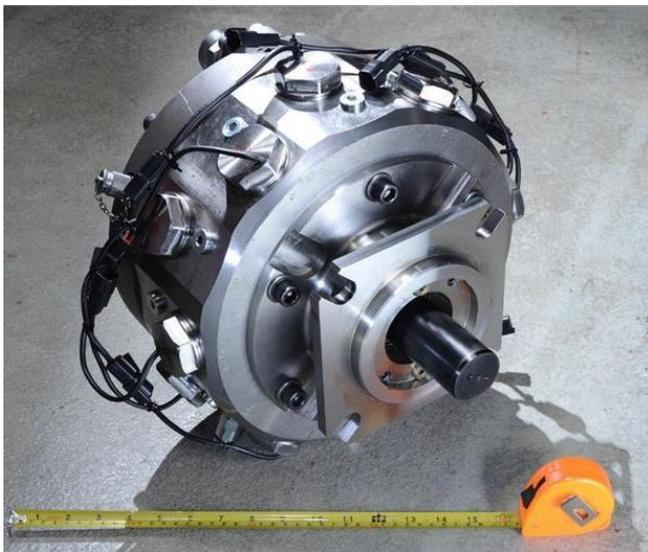
**FIGURE 5:** THE M96 DDPM USED IN THE TESTS.
