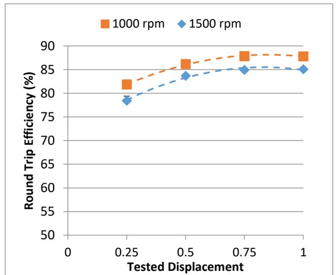
**FIGURE 7:** ROUND TRIP EFFICIENCY RESULTS AT 180 BAR.
