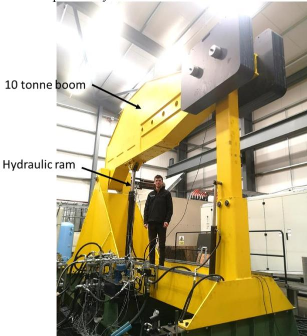
**FIGURE 4:** THE MOTION CONTROL RIG USED TO TEST THE ROUND-TRIP EFFICIENCY. THE 10-TONNE BOOM CAN BE SEEN IN YELLOW, AND THE AUTHOR IS SHOWN, FOR SCALE.
