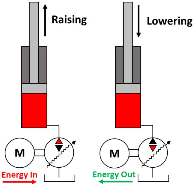
**FIGURE 3:** SIMPLIFIED HYDRAULIC SCHEMATIC AND ENERGY FLOWS IN ROUND TRIP EFFICIENCY TEST.
